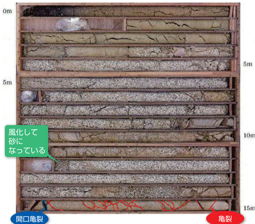
ボーリング調査で得られた基岩のサンプルを深さ1メートル分ずつ横にならべたもの。亀裂の情報をデジタル化して孔隙率（岩石中のすきまの体積の、岩石全体の体積に対する比率）を割り出し、貯水量を推測する。
