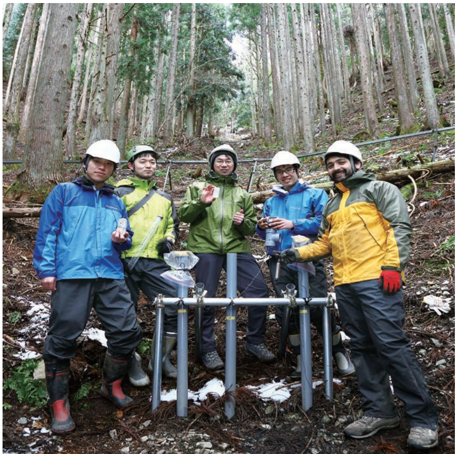
葛川流域（滋賀県大津市、p.5左上）の調査地点で。調査ボーリングの跡の孔に塩ビ管を通し、山体地下水についてさまざまな調査をする。塩ビ管の地中側の先端部側面には穴があげられており、地下水水位が上がると塩ビ管内の水位も連動して上がる。地下水をサンプリングして水質を調べるほか、複数のボーリング孔や雨水のイオンの構成比などを比較することで、雨水や山体地下水の動きを解析できる。中央が小杉さん。
