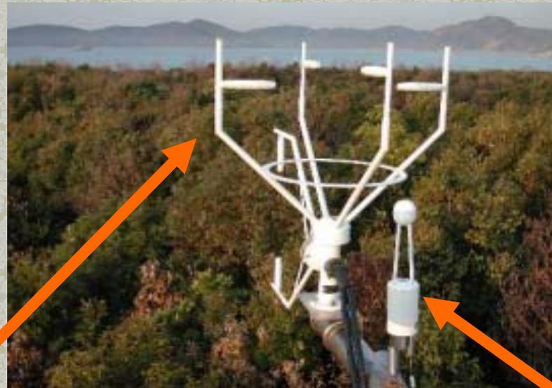
x,y,z方向の風速と温度の変動
